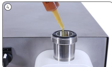
Pod kryt čerpadla umiestnite nádobu/misu. Zriedte kryt čerpadla požadovanou látkou, ktorou ho chcete naplniť. Naplňte ho až po okraj armatúry.
