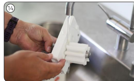
14 Opatrne stlačte pevnú os, aby sa medzi ozubeným kolesom a krytom vytvorila medzera. Opláchnite túto časť.
