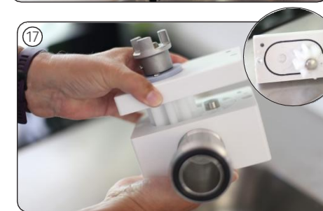
17 Znovu zložte telo čerpadla . Tip: O-kružok je možné pre extra tesnenie namazať tukom alebo plniacou látkou.
