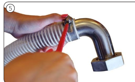
Namontujte hadicu na armatúru. Je dôležité namontovať hadicovú svorku za vyvýšenie a potom skontrolovať, či hadica nie je prasknutá!
