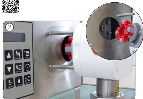
Namontujte skriňu čerpadla na stroj. Nezabudnite, že zuby spojky musia byť v správnej polohe, inak sa nedajú.
