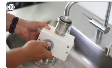
10 Opláchnite čerpadlo vodou a zároveň otáčajte spojku. Tým sa med uvoľní a bude ľahšie otvoriť kryt čerpadla.
