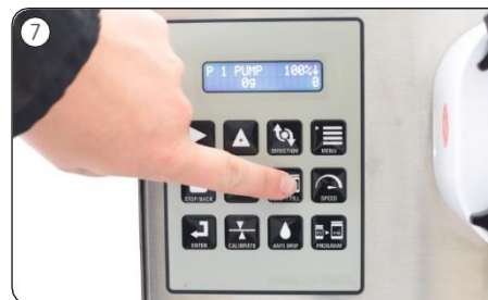
Stlačte tlačidlo [PUMP/FILL] a nastavte stroj na čerpanie.
